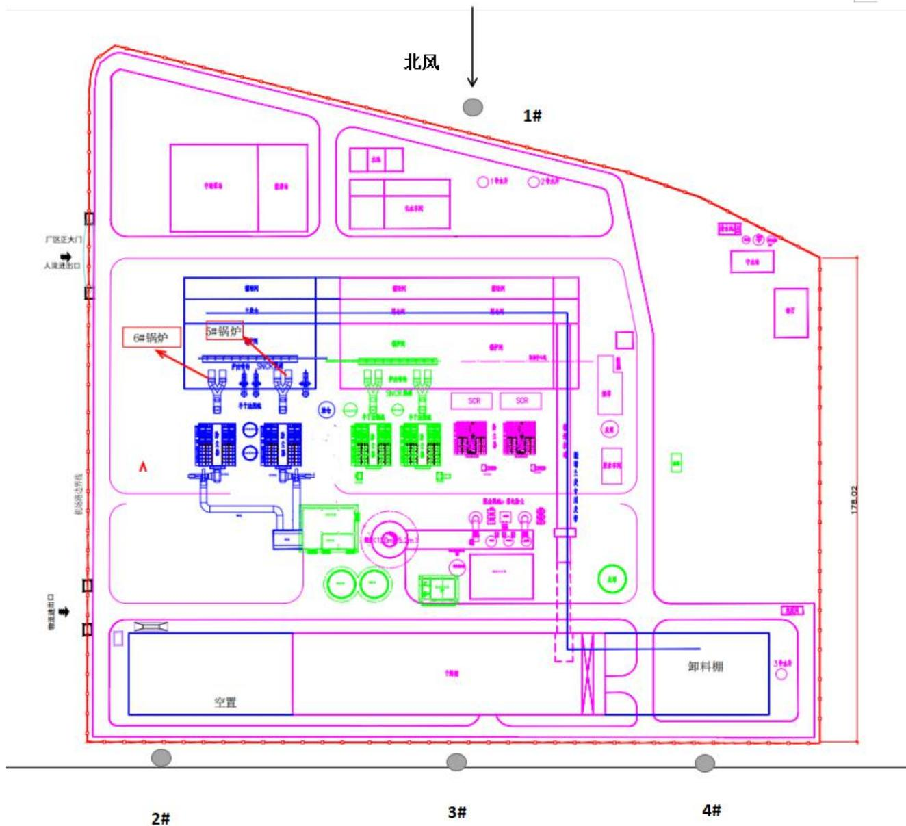
图 7.1-4 废气监测布点图 (● 无组织监测点位) -2021.1.23
