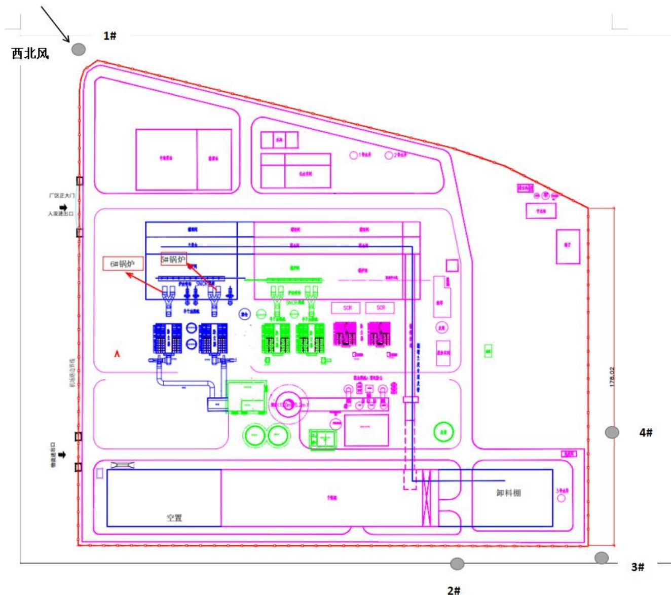
图 7.1-3 废气监测布点图 (● 无组织监测点位) -2021.1.22
